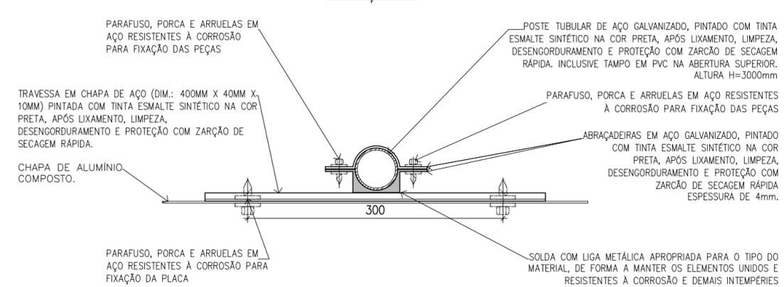
**4** DETALHE 01 - CORTE ESQUEMÁTICO - FIXAÇÃO DO POSTE
