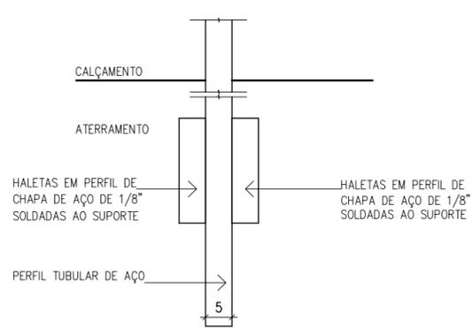
**2** DETALHE 02 - CORTE ESQUEMÁTICO
