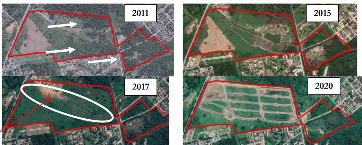
Figura 3: Histórico de intervenções realizadas no terreno entre os anos 2011 e 2020. As setas indicam algumas áreas onde está claramente evidenciada a supressão de vegetação arbórea para a implantação do terreno, que ocorreu antes da obtenção da LPI. A elipse branca evidencia o aterramento de trecho do Rio Jabaquara. (Imagens obtidas por meio do programa Google Earth, acessado em setembro de 2020).
