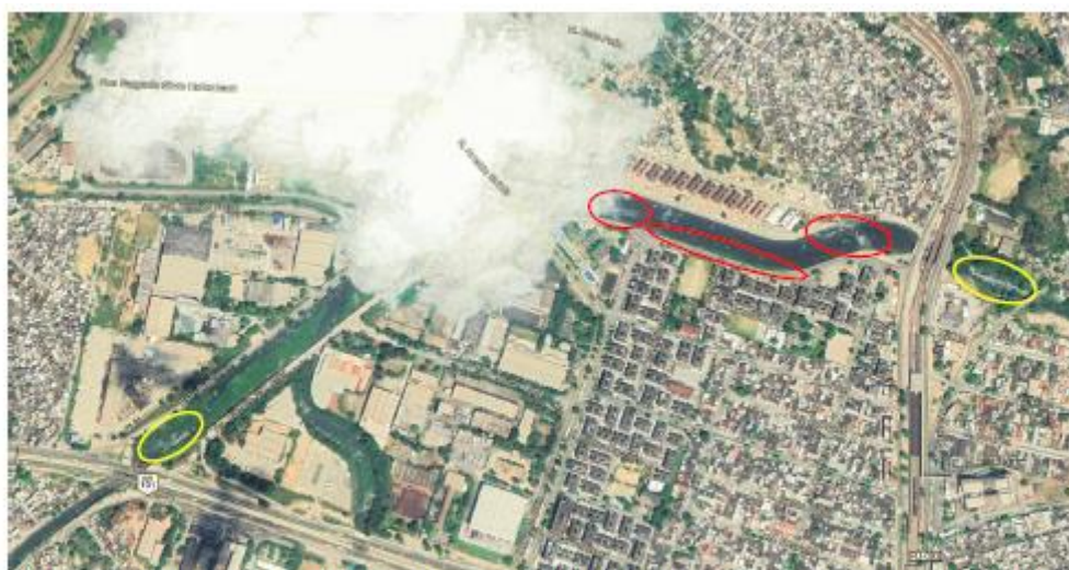
Figura 5 – Imagem adaptada do software Google Earth Pro, datada em 13/01/2019, onde podem ser percebidos o acúmulo de sedimentos no trecho desassoreado no primeiro semestre de 2018, notadamente nos pontos destacados em vermelho. Em amarelo, destaque para manchas que indicam o acúmulo de resíduos sólidos na calha do rio Acari.
