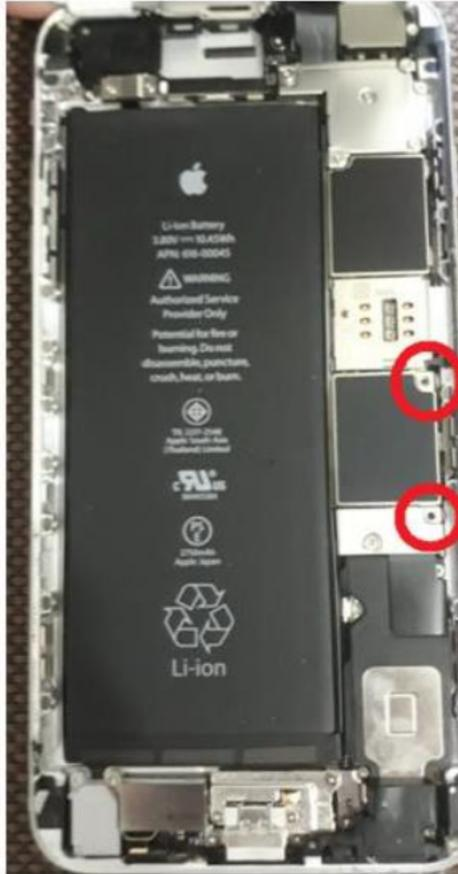
Figura 8 - Parafusos internos faltantes no *iphone* A1687.
