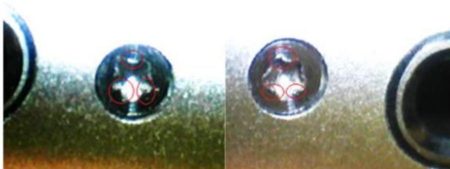
Figura 7 – Detalhe das marcas de atrito nos parafusos de fixação da tela do *iPhone* A1687.
