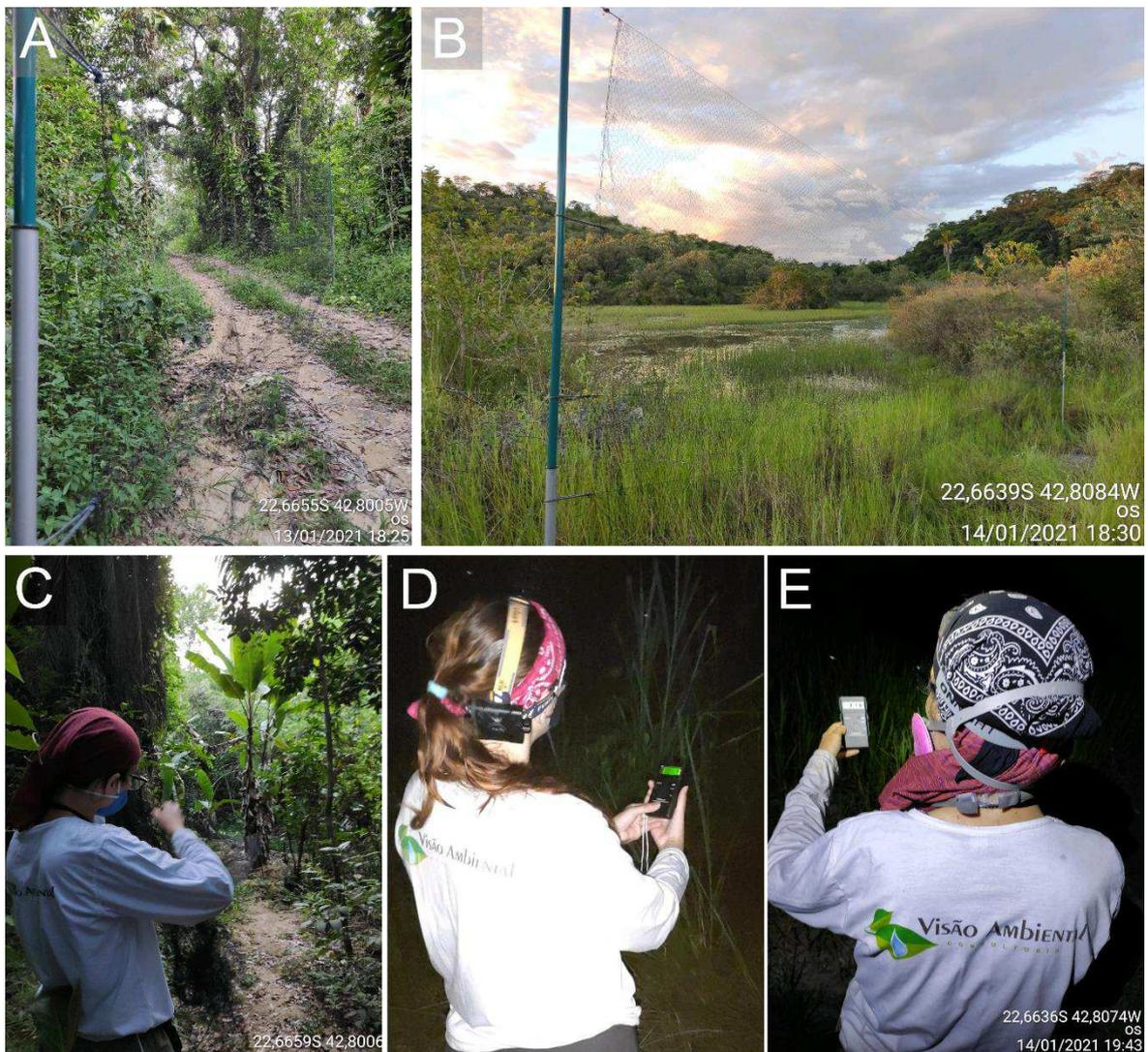
**Figura 10** – Metodologias utilizadas para amostragem da quiropterofauna nas estações amostrais da Fazenda Macumba, área de influência direta do Comperj, RJ. (A-B) Redes de neblina abertas; (C) Redes de neblina sendo montadas; (D-E) Detector de morcegos.
