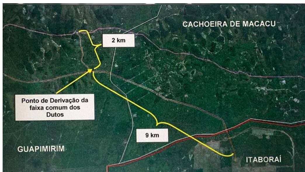
Figura 2 – Traçado do Gasoduto do COMPERJ (fl.58).
